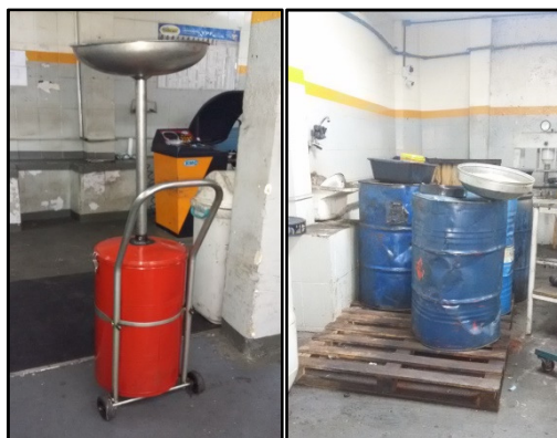
Figura 1. Coletor de óleo no empreendimento (esq.) e armazenamento do óleo usado (dir.). Fonte: Os Autores.
